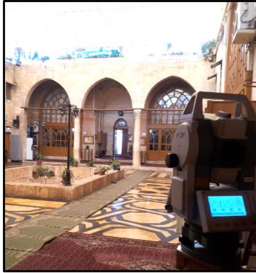
الصورة (9): مكان تمرکز الجهاز المساحي لرصد النقاط 1
